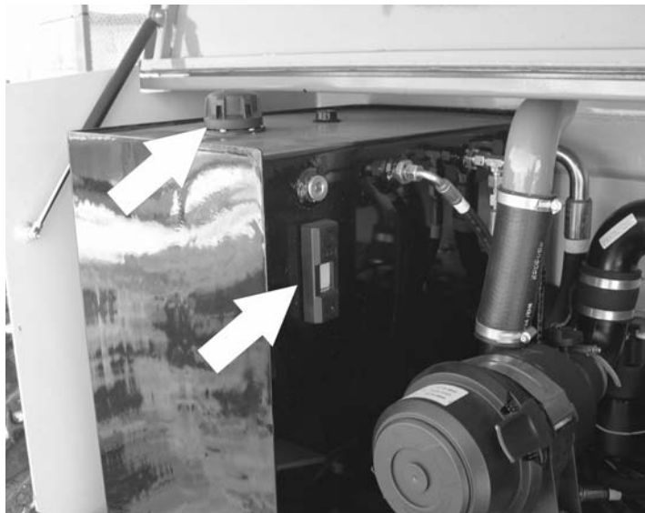
б. Проверка уровня гидравлического масла/доливка
