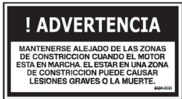
Ubicada a ambos lados del chasis cerca de los ejes N° de pieza 9134-3131
