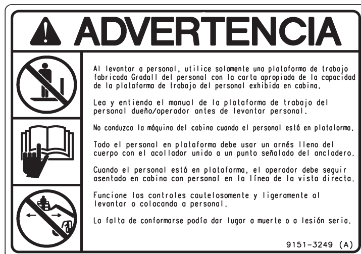
Ubicada en la pared derecha de la cabina y la cabeza de la pluma N° de pieza 9151-3249
