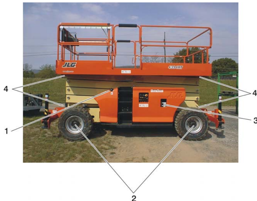
6-7. ábra. Kezelői karbantartás és kenési vázlat
