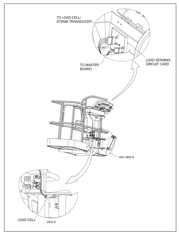
Figure 4-7. Load Sensor
