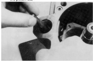
**16.** Disassemble the swashplate.
