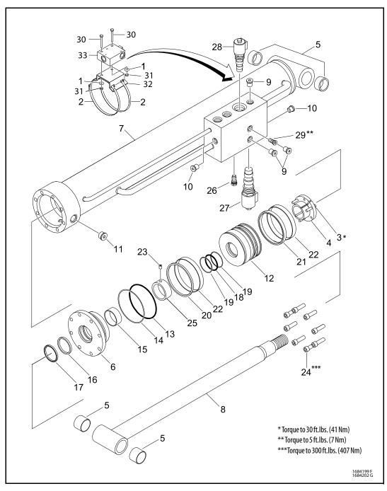
1. Flatwasher 8. Rod 15. Wear Ring 22. Guidelock Ring 29. Relief Valve 2. Clamp 9. Plug 16. Rod Seal 23. Setscrew 30. Bolt 3. Bolt 10. Plug 17. Wiper Seal 24. Capscrew 31. Locknut 11. Plug 18. 0-ring Tapered Bushing 25. Spacer 32. Plate 5. Bushing 12. Piston 19. Backup ring 26. Check Valve 33. Check Valve 6. Head 13. 0-ring 20. Guidelock Ring 27. Lift Dump Proportional Solenoid Barrel 14. Backup Ring 28. Lift Holding Solenoid 7. 21. Seal
