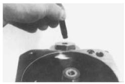
13. Disassemble the plug.
