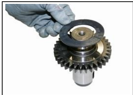
14:18 Replace the upper thrust disc.
